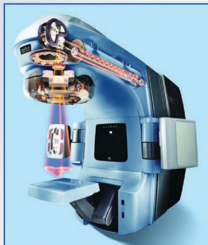
ئاراستە کردنی تیشکدان بۆ سەر شیوەی خانە شیرپەنجەییە کان لە پێی Multi Leaf Collimator
