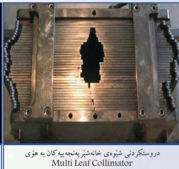
ئاراستە کردنی تیشکدان بۆ سەر شیوەی خانە شیرپەنجەییە کان لە پێی Multi Leaf Collimator
